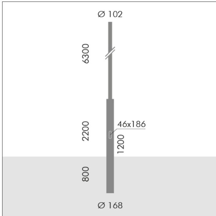
**S.2817****PALO CILINDRICO RASTREMATO H 8,5m f.t., Ø168mm
