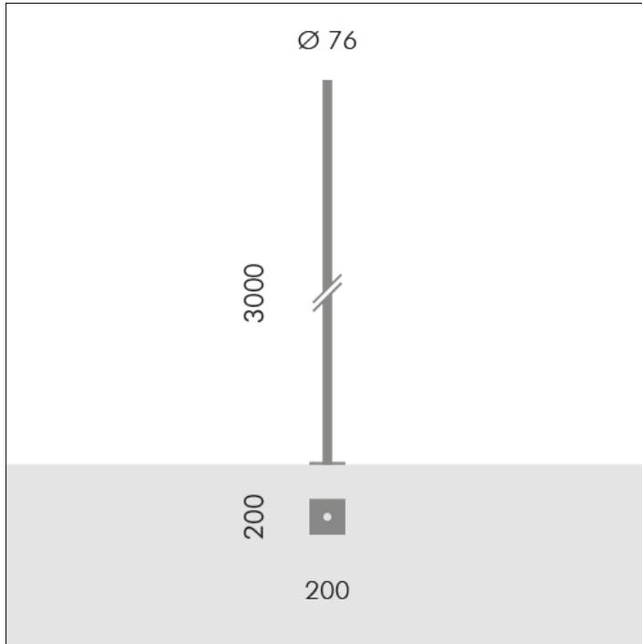
**S.2813****ZYLINDRISCHER MAST H 3,0m Ø76mm MIT
