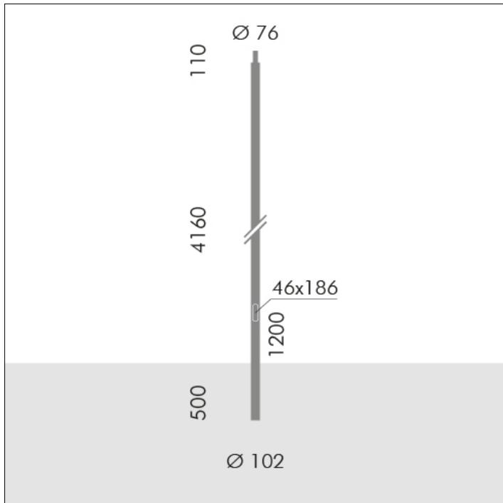
**S.2811****ZYLINDRISCHER MAST H 4,16m Ø102mm MIT
