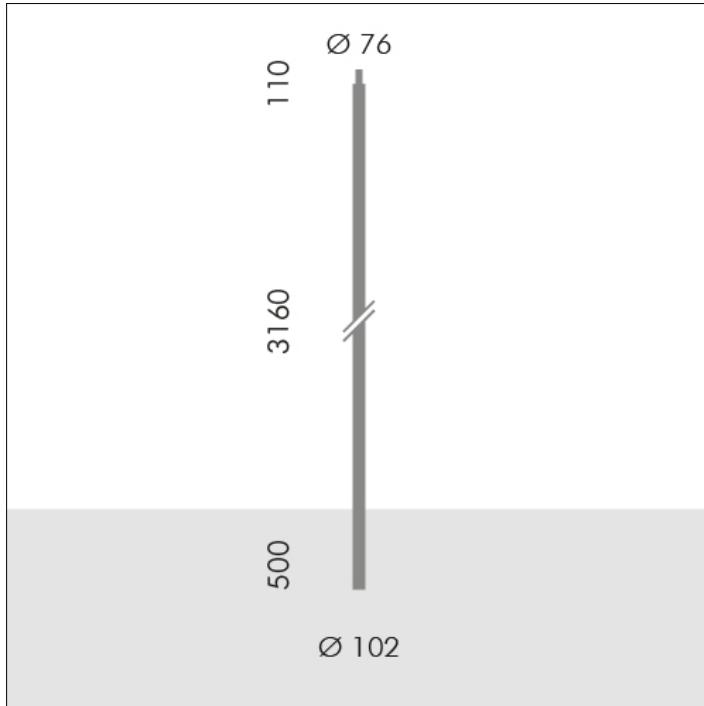
**S.2810****ZYLINDRISCHER MAST H 3,16m Ø102mm MIT
