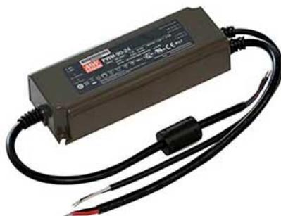
**S.2428****ALIMENTATION ELECTRONIQUE DIMMABLE 1-10V****90W 230Vac/24Vdc 1,47KHz IP67**
