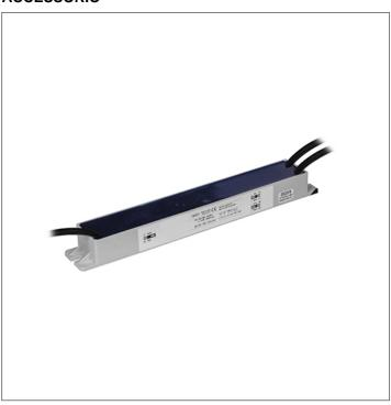
S.2416 ALIMENTATORE DIMMERABILE DALI 2 230Vac/24Vdc 75W 244Hz IP67
